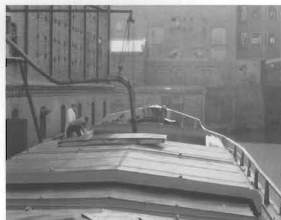
Beim Entladen eines gedeckten Schütt- gutkahns mittels Schiffssauganlage
